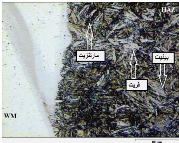
شکل ۱۸- تصویر میکروسکوپی نوری از ریزساختار منطقه HAZ در فولاد ۴۱۳۰، جوشکاری شده توسط ERNiCr-۳
